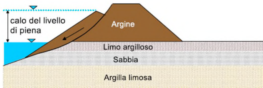
Instabilità del paramento interno
